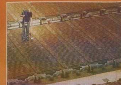
Tausende Anodenplatten hängen in Elektrolysebehältern. Unter Stromeinfluss bekommt das 99,9-prozentige Kupfer hier eine Reinheit von 99,9 Prozent.
